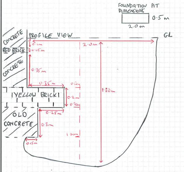
0.0-0.10: CONCRETE 0.10-0.15: RED BRICK 0.15-0.70: MADE GROUND: BROWN SLIGHTLY SANDY SLIGHTLY GRAVELLY CLAY WITH CONCRETE FRAGMENTS 0.70-1.30: MADE GROUND: BROWN SLIGHTLY SANDY GRAVELLY SILTY CLAY WITH SOME COROLES AND BONLDERS
